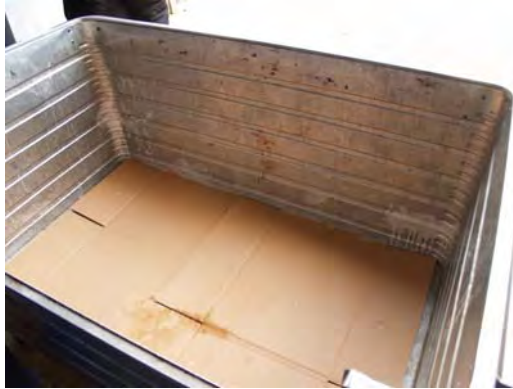
Abb. 5.13.2 Transportwagen mit Pappe ausgelegt als Schutz gegen auslaufende Flüssigkeiten
