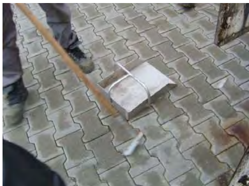
Abb. 6.5 Selbst konstruierte Schaufel zur Entleerung des Hydraulikbereichs vor der Durchführung von Reparaturen
