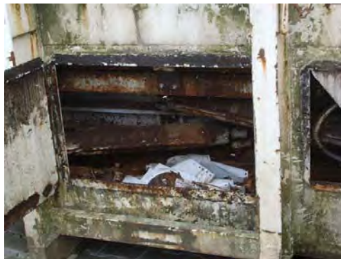
Abb. 6.2 Müllreste im Hydraulikbereich des Presscontainers
