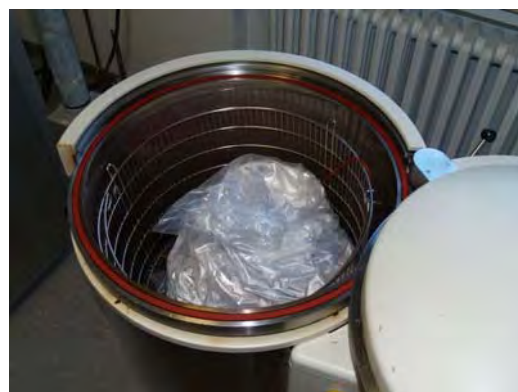
Abb. 5.11.6 Einschweißgerät für Zytostatikaabfall
