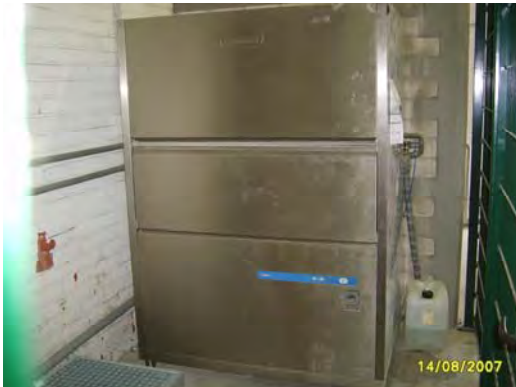
Abb. 5.10.3 Reinigungs- und Desinfektionsgerät für Glassammel- und Transportbehälter
