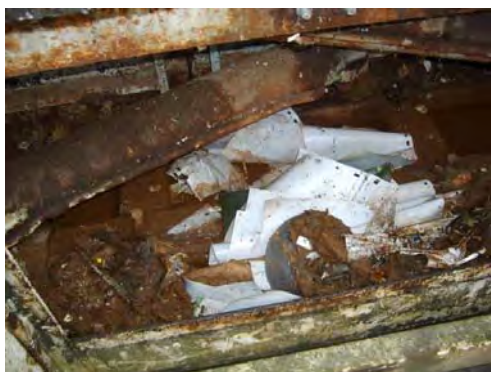
Abb. 6.3 Müllreste im Hydraulikbereich des Presscontainers
