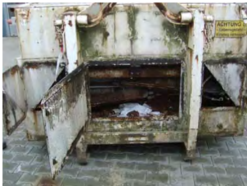
Abb. 6.1 Geöffnete Wartungsöffnung eines Presscontainers
