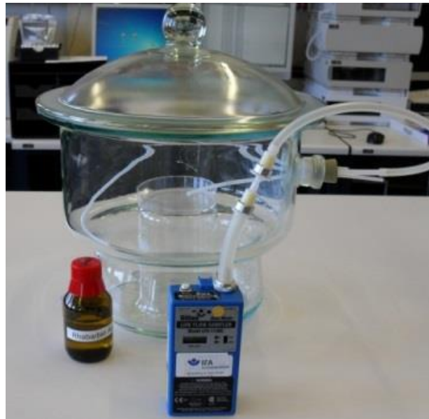
Abbildung 1: Versuchsaufbau Emissionsmessungen bei Raumtemperatur
