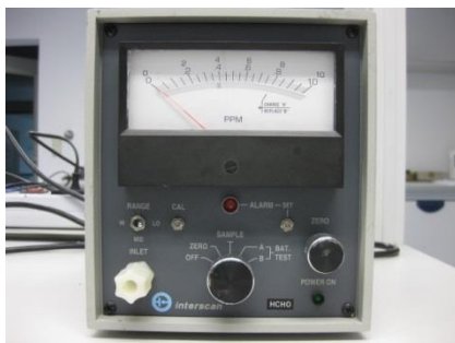
Abbildung 3: Direktanzeigendes Formaldehydmessgerät Interscan 1166
