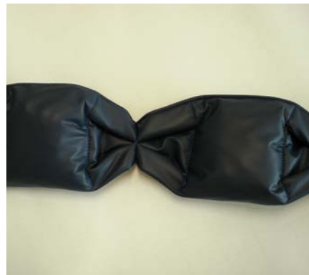
Abbildung 10: Benetzungslücken beim Bettzügen.
