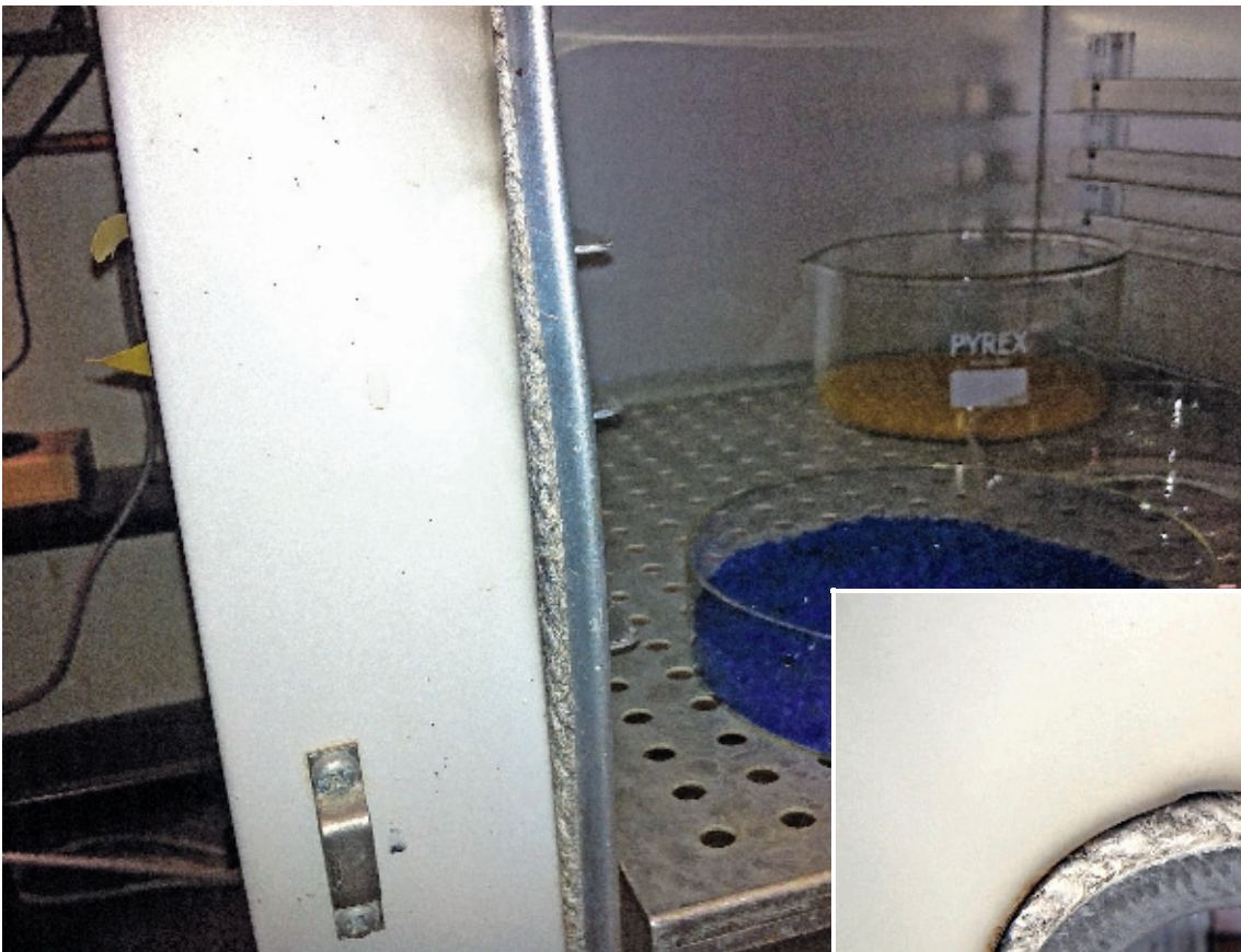
Abb.1: Trockenschrank mit asbesthaltiger Schnur als Isolierung. Das Detailbild zeigt erkennbare Beschädigungen der asbesthaltigen Schnur.
