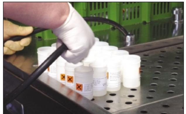
Befüllen von Probengefäßen mit 4%iger Formalinlösung aus einem Dispenser
