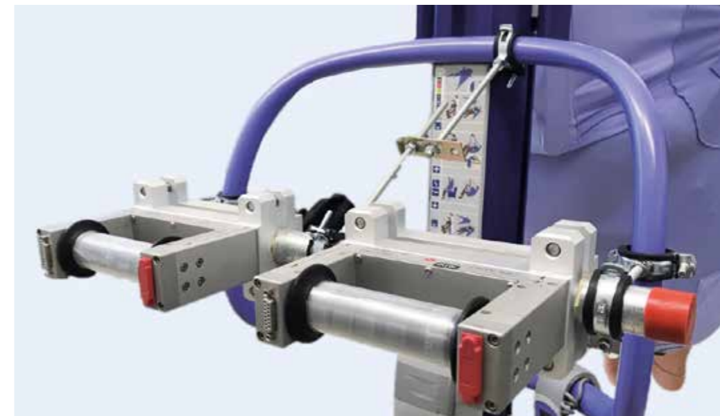
Dieses Gerät misst die Kraft beim Anschieben und Bremsen eines Personenlifters.
