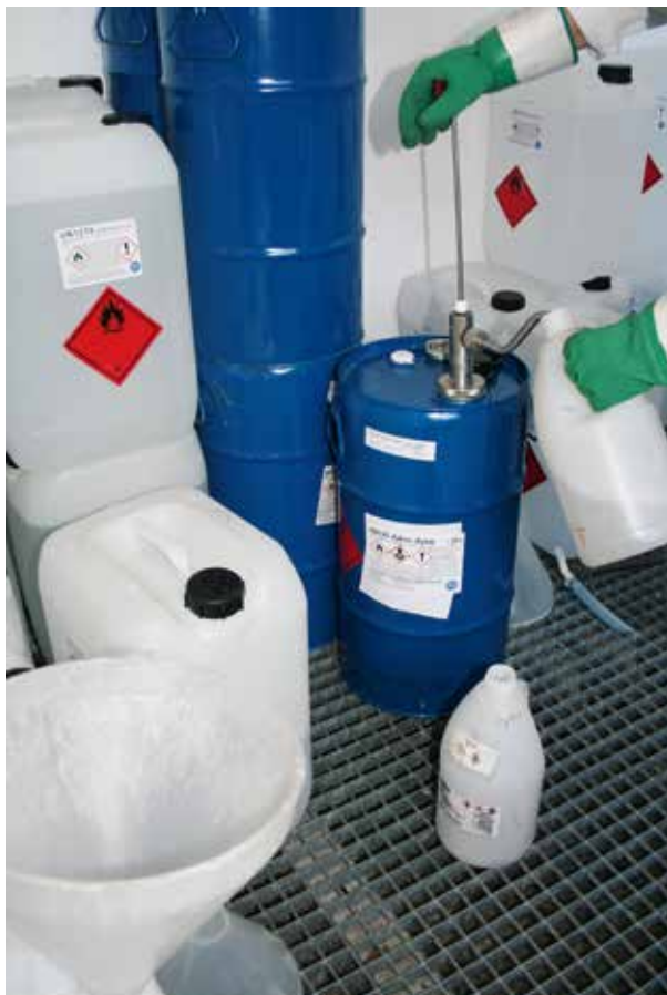
Umfüllen von Xylol im Lagerraum mit einer Fasspumpe
