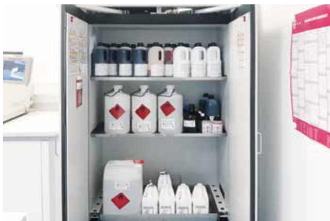
Selbstschließender und -verriegelnder Sicherheitsschrank zur Aufbewahrung entzündbarer Flüssigkeiten in einer Pathologie
