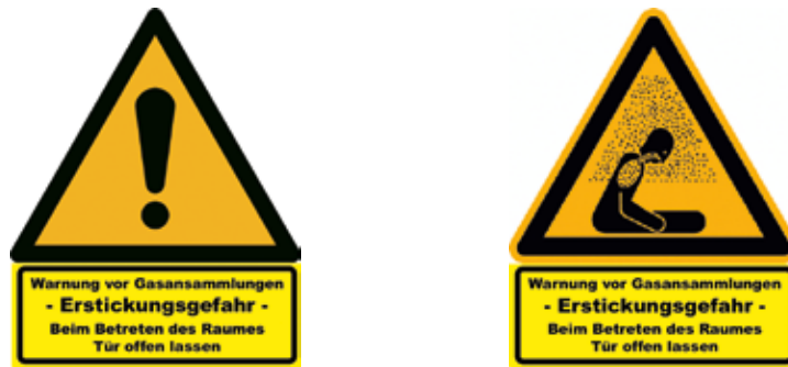
Warnzeichen zur Warnung vor Erstickungsgefahr
