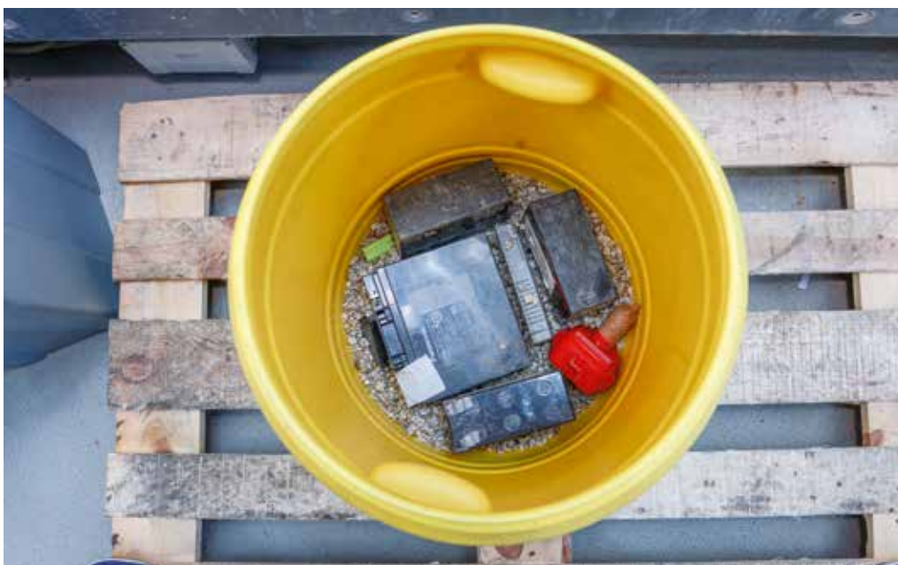
Abfallbehälter mit beschädigten Akkus und Vermiculit
