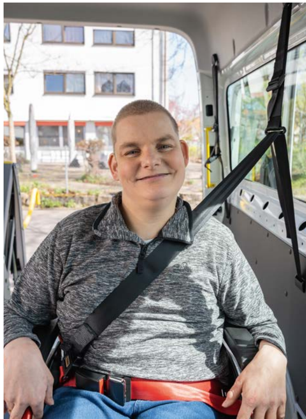
Becken- und Schultersträgurgurt bilden das Drei-Punkt-Insassenrückhaltesystem.
