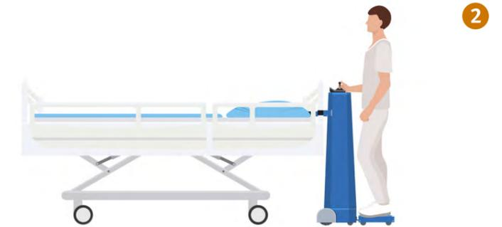
Beispielhafte Produktvariante 2: Die Pflegekraft steht auf einem Bed Mover mit Plattform, montiert am Kopfende des Bettes.
