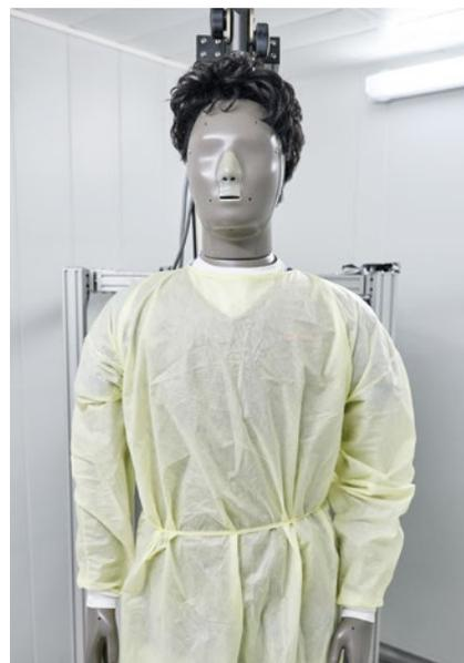
Die Vermutung: Ob die Kühlweste über oder unter Arbeitskleidung getragen wird, könnte die Kühlwirkung negativ beeinflussen. Foto links: Kühlweste über dem Kasack; Foto Mitte: Kühlweste unter dem Kasack; Foto rechts: Kühlweste über dem Kasack und unter einem Schutzkittel.
