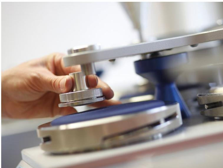
Scheuerprüfung: Wie unempfindlich verhält sich der Westenstoff gegen Abrieb und Verschleiß?
