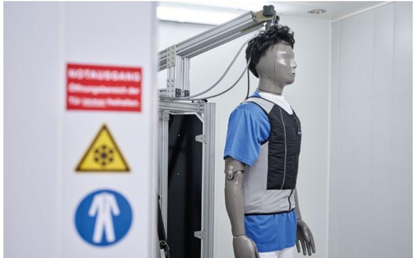
Jede Kühlweste wurde in der Klimakammer an der thermischen Puppe auf ihre Kühlleistung über und unter der Arbeitskleidung geprüft.
